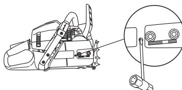
Цепь считается натянутой правильно, если она свободно проворачивается рукой. После этого , удерживая носок пильного полотна в верхнем положений, затяните гайки крепления пильного полотна универсальным ключом.
