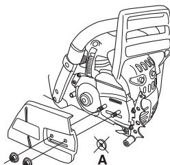
Установите пильное полотно на специально предназначенные болты. Установите полотно в самое заднее положение. Оденьте цепь на ведущую звездочку и вставьте ее хвостовики в паз пильного полотна. Начинайте с верхней стороны пильного полотна.
