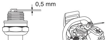
Обратите внимание! Всегда используйте только указанный тип свечи. Применение несоответствующей модели может привести к серьезным повреждениям поршня/цилиндра. Следите за тем, чтобы свеча была оснащена т.н. изоляцией радиопомех.
