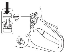
двигатель останавливается, когда контакт остановки будет передвинут в положение остановки.
