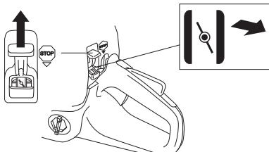
**Газ запуска:** Положение комбинации съятение/газ запуска получим когда установим ручку в положение съятния.
