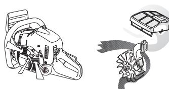
**ВАЖНО!** Для осуществления метода центробежной очистки нужно постоянно выполнять техническое обслуживание и уход за системой. Необходимо чистить воздухозаборник стартера, лопасти вентилятора на маховике, пространство вокруг маховика, входного коллектора и карбюратора.
