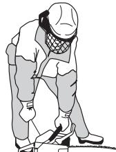
После того, как двигатель сделает первую вспышку, верните сразу рычаг воздушной
