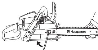
При установки новой цепи следует часто проверять ее натяжение , пока цепь не приработается. Регулярно проверяйте натяжение цепи. Регулярно проверяйте натяжение цепи. Правильно натянутая цепь обеспечивает высокое качество пиления и дольше служит.
