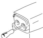
В некоторых глушителях предусмотрен специальный искрогаситель. Если ваша машина оборудована таким глушителем, сетку фильтра следует чистить раз в неделю. Наилучшие пользоваться стальной щеткой. Забитая решетка приводит к работе с горячим двигателем, что дает серьезные повреждения двигателя.
