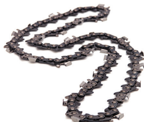
ПИЛЬНАЯ ЦЕПЬ 12"/30CM, H37, 3/8" MINI, 1.3MM, 45 ХВОСТОВИКОВ 576 93 65-40
