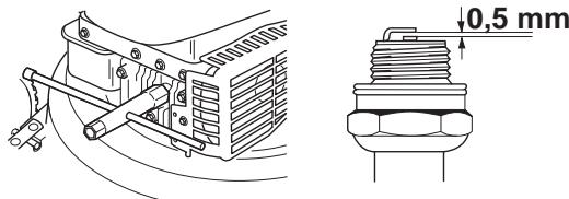
**ВНИМАНИЕ!** Използвайте винаги запалителните свещи от препоръчания вид! Използването на погрешен тип свещи може да предизвика сериозни повреди на буталото/цилиндъра.
