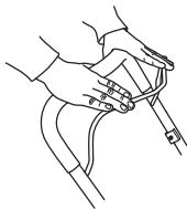
Запрещается на продолжительное время закреплять ручку тормоза при работающей машине.
