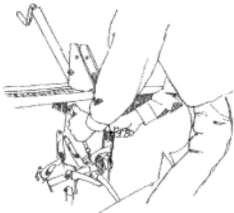
5. Осторожно затяните болты 1/2" и 3/8". Болт 3/8" потребует использования скважинного ключа 9/16".
