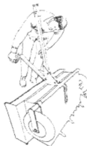
8. Проверка работы домкрата путём подъёма колёс транспорта в самую высокую позицию перед тем, как привести азратор в рабочее состояние. Полностью опустите транспортные колёса перед подъёмом азратора.
