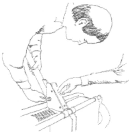
3. Вставьте болт 1/2"x3" и шайбу через раму и домкрат. Закрутите контргайку 1/2" с шайбой и затяните.
