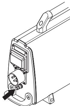
Другой разъем для подачи воды необходимо подсоединить к электроинструменту: электроинструменты оборудованы различными регуляторами расхода охлаждающей жидкости на инструменте. См. руководство по эксплуатации соответствующих электроинструментов.
