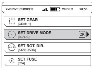
Кроме того, существует возможность выбора режима работы на главном экране с помощью кнопок со стрелками.
