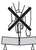
Если диск зажат или застрял в зоне отдачи, сила реакции будет толкать устройство вверх и назад к оператору вращательным движением, что может вызвать опасную или даже смертельную травму.
