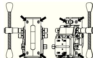
9. Настройте зазор между колонкой и кареткой настроечными винтами.
