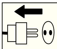
Дефектоскопия и/или обслуживание должны выполняться при выключенном двигателе и разъединенном штекселе.
