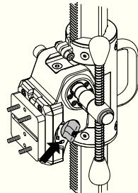
2. Ослабьте стяжной болт фиксатора захвата.
