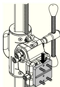
5. Затяните стяжной болт фиксации захвата.
