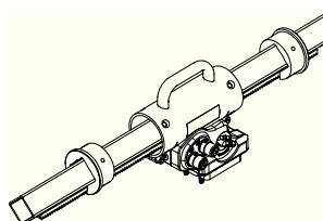
**ВАЖНО!** Поверхности втулок должны быть параллельны.
