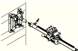
Каретки стендов имеют две передачи: 2.5:1 и 1:1. Рычаг подачи может быть установлен с обеих сторон каретки.
