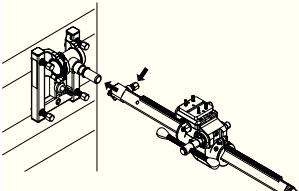
Колонка может быть повернута на 360°. С помощью стяжного винта колонка может быть развернута в четыре положения
