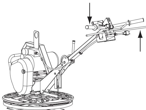
**Регулировка углового положения лопастей.**
