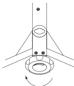
◆ Чтобы уменьшить угол, под которым расположены лопасти, нужно вращать ручку плавной регулировки против часовой стрелки.
