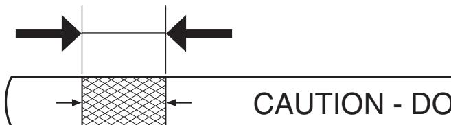
**RU** Уровень масла должен находиться между двумя метками на масломерном щупе. При необходимости долейте масло до верха штрихованной метки на щупе. Примерное количество и тип масла см. в разделе "СПЕЦИФИКАЦИЯ ПРОДУКТА" данного руководства. Не следует заливать жидкость в количестве, превышающем норму.
