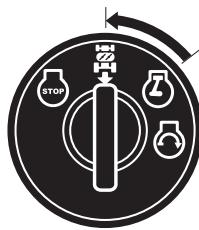
Положение двигателя "ON" (обычная работа)
