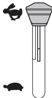
(RU) Переведите рычаг управления газом в положение полной мощности "↑".
