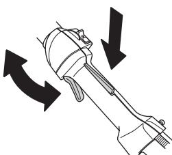
См. указания в разделе Пуск. Запустите ножницы для живой изгороди и откройте полностью газ. Отпустите ручку газа и проверьте, чтобы ножи останавливались и оставались неподвижными. Если ножи вращаются на холостом ходу, отрегулируйте холостой ход карбюратора. См. раздел Техническое обслуживание.
