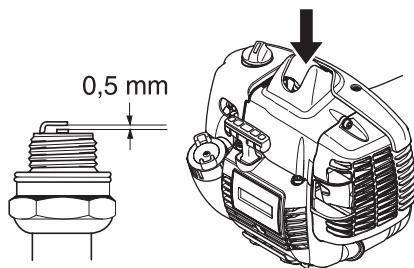
**ВНИМАНИЕ!** Всегда используйте только указанный тип свечи! Применение несоответствующей модели может привести к серьезным повреждениям поршня/цилиндра. Следите за тем, чтобы свеча была оснащена т.н. изоляцией радиопомех.
