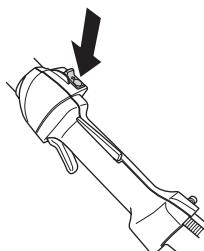
Запустите двигатель и проверьте, чтобы он остановился при переводе выключателя в положение стоп.
