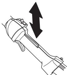
Проверьте, чтобы ручка газа и блокировочный рычаг перемещались свободно и чтобы возвратные пружины работали соответствующим образом.
