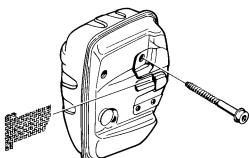
Если на вашем инструменте стоит глушитель такого типа, то сетку следует очищать не реже одного раза в неделю. На глушителях с катализатором, такую очистку достаточно производить раз в месяц. При возникновении повреждений на сетке ее следует заменить.
