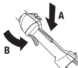
Проверьте, чтобы ручка газа в момент возвращения блокировочного рычага в
