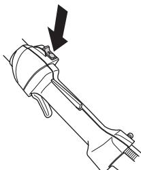
**ВНИМАНИЕ!** Контакт остановки автоматически возвращается в положение запуска. Во избежание непроизвольного запуска, колпачок зажигания следует всегда снимать со свечи зажигания при монтаже, проверке и/или обслуживании.
