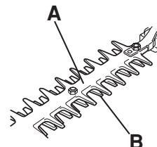
Проверьте щиток ножа, чтобы он не был поврежден и деформирован. Замените щиток ножа, если он согнут или поврежден.
