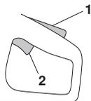
Когда ручка на рукоятке отпускается, курок газа и рычаг его блокировки возвращаются в исходное положение. В этом положении машина останавливается, а курок газа блокируется, в то время как клапан подачи воды возвращается в закрытое положение.
