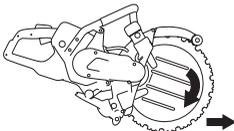
Не передвигайте машину, если резчик вращается. Гироскопические силы могут затруднить движение в выбранном направлении.
