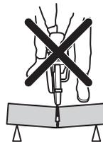
Если диск зажатым или застрял в зоне отдачи, сила реакции будет толкать устройство вверх и назад к оператору вращательным движением, что может вызвать опасную или даже смертельную травму. Следите за возможными перемещениями распиливаемого элемента. Если распиливаемая деталь неправильно закреплена и смещается при резке, может произойти заклинивание режущего диска и возникнуть отдача.
