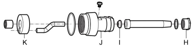
7. С помощью соответствующего стержня и киянки аккуратно надавливать на держатель подшипника (K), чтобы извлечь его.
