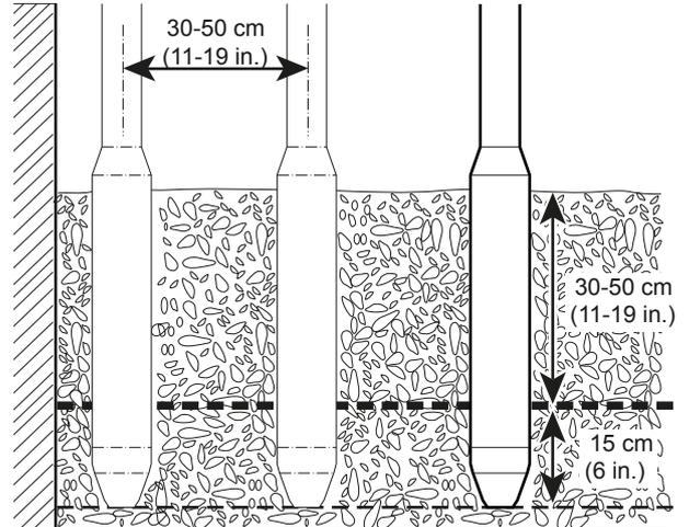
3. Вставьте вибратор вибробулавы вертикально на расстояние в 8-10 раз превышающее диаметр трубы между вставками.
